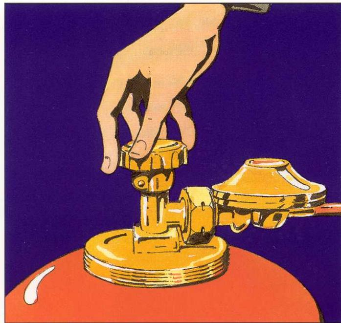
**2** Undichte Gasflaschen aus den Räumen entfernen und an einen sichern Ort im Freien bringen.
